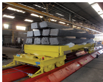
Chariot 35 tonnes en test de charge sur voie de grue.
